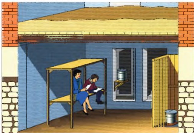
Рис. 4 — Подвал, приспособленный под укрытие
